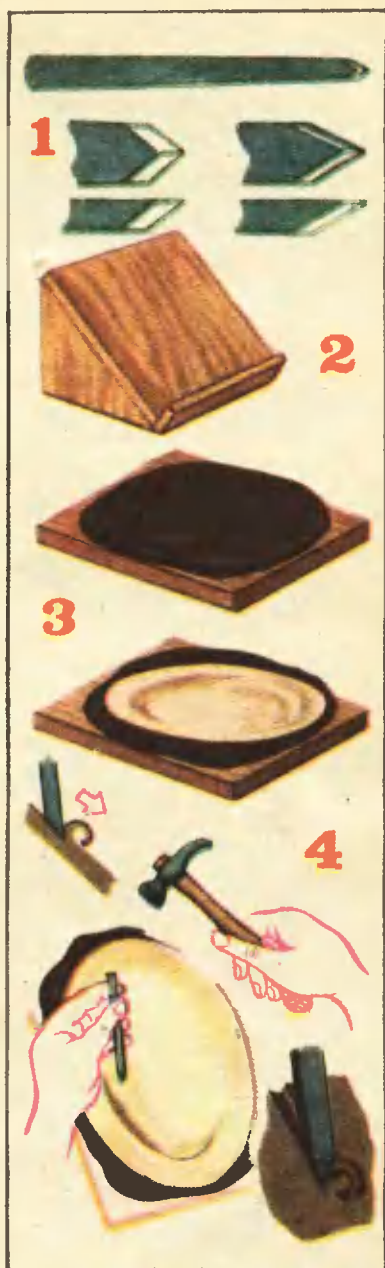
1 — налам (резец для чекайки); 2 — подставка; 3 — укрепление тарелки из смоляной подушке; 4 — положение налама и молотка при выполнении чекайки.
